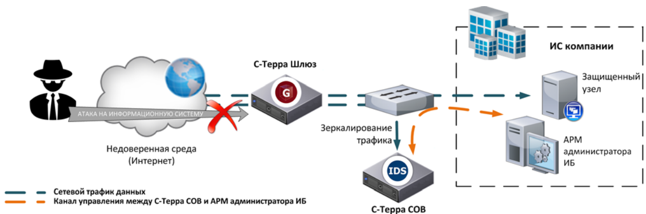
Рисунок 1. Схема включения отдельных С-Терра COB и С-Терра Шлюз
